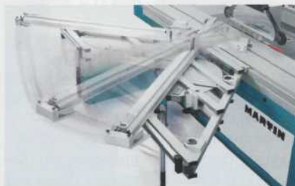
T 74: Parallelogrammquertisch für passgenaue Winkelschnitte
