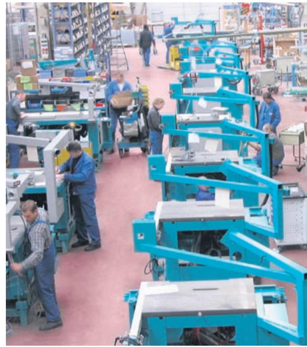
Durch verbesserte Montagelogik konnten die Durchlaufzeiten jeder Maschine von drei Wochen auf zwei Tage reduziert werden: Die neue Fließfertigung im Hause MARTIN.
