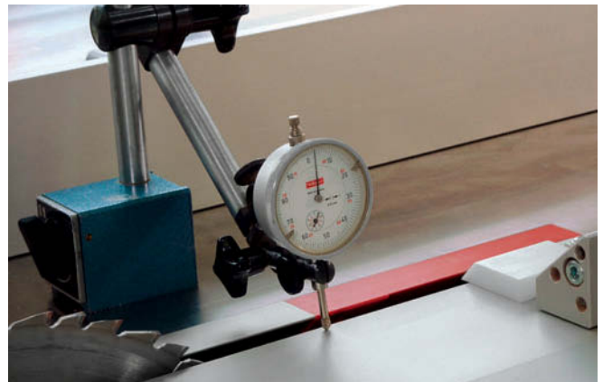
8 Stolzter Wert: 100 kg Belastung am Ende des Schiebeschlittens verändern die Höhe am Sägeblatt nur um 0,01 mm
