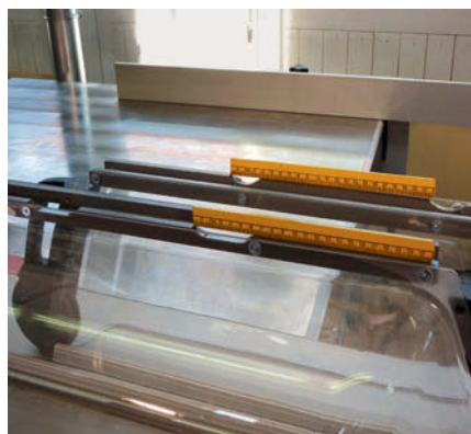
3 Intelligent: An den Aussparungen erkennt die Maschine, ob sie die Säge schwenken darf
