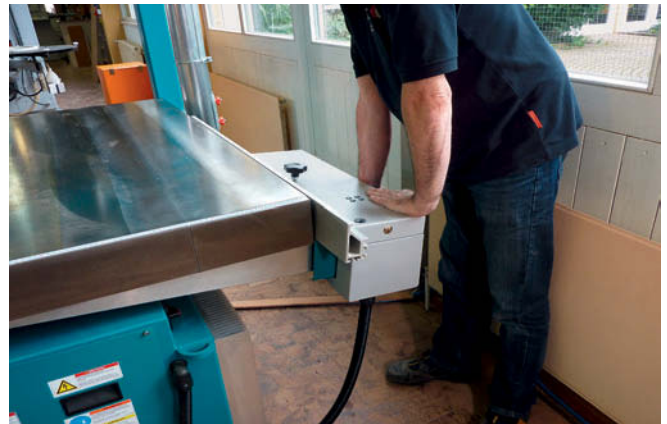
6 Zack und weg: Mit einem leichten Druck verschwindet der Parallelanschlag unter dem Tisch
