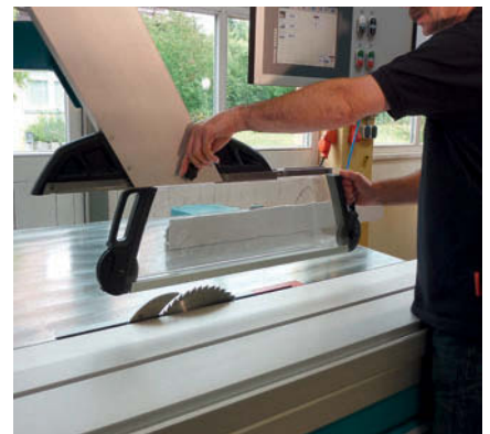
2 Supereinfach zu wechseln – da montiert jeder die Spanhaube gerne auch wieder zurück
