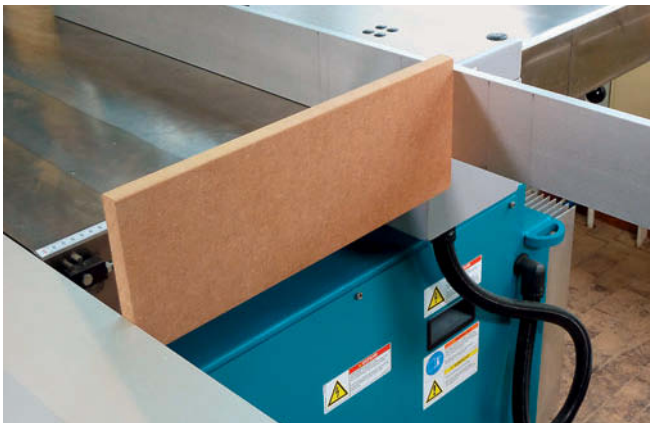
7 Sicher: keine Quetschgefahr, wenn sich eine Person zwischen Schiebeschlitten und Parallelanschlag aufhält
