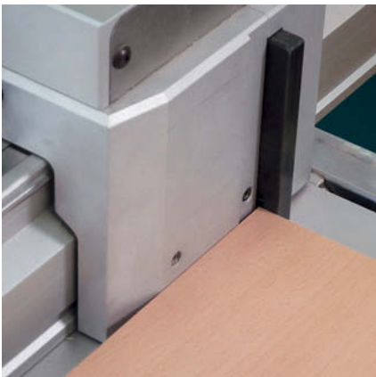
10 Clevere Nische: Luft zwischen Anlagefläche und Anschlagzunge
