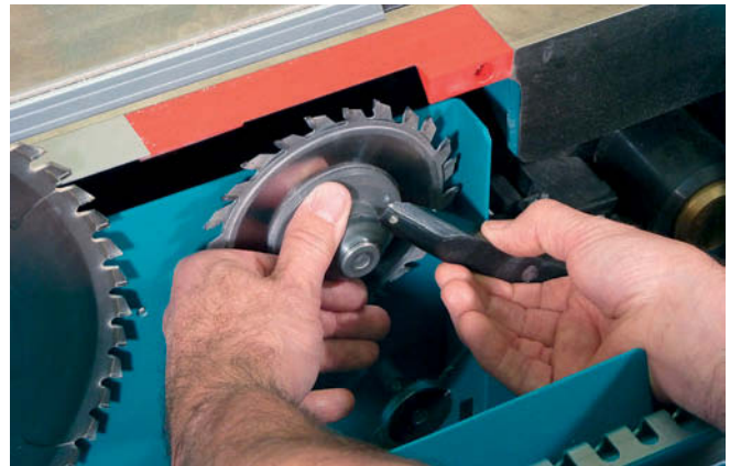
12 Kinderleicht ausgerichtet: Eine Feder drückt die linke Hälfte des Vorritzers gegen einen CNC-gesteuerten Arm
