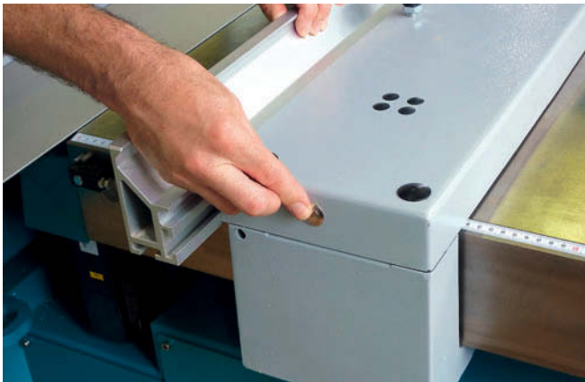
5 Der magische Knopf: Der Parallelanschlag lässt sich auch im Nu von Hand verstellen oder in die Parkposition schieben
