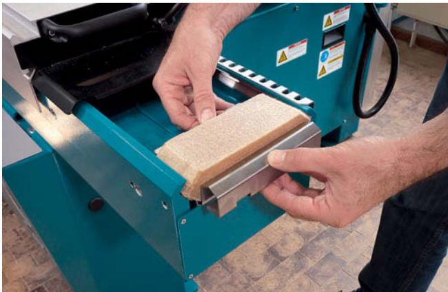
11 Stets gut geschmiert: Bei jedem Verschieben des Schlittens benetzt dieser Schwamm die Führungen mit Öl
