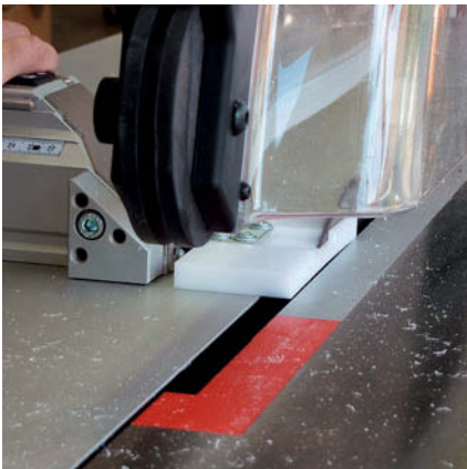
9 Nicht erschrecken: Der Splitterschutz ist beim ersten Schnitt abzulängen
