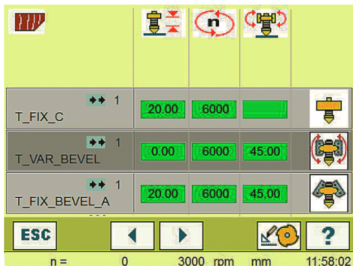
Welches Werkzeug ist am besten geeignet? In der Werkzeug-Vorschlagsliste gibt der Fräs-Assistent die Antwort
