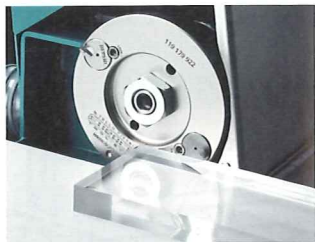
Ermöglicht Hochglanzzuschnitte: das neue Stirnplanfräsaggregat
