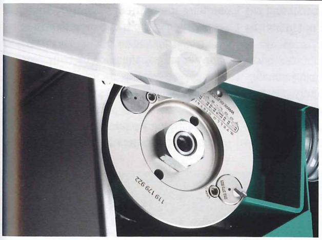
□ Zusatzaggregat an einer T74, mit dem direkt nach dem Zugschnitt einer PMMA Platte die Kante "poliert" werden kann (Foto: Martin)
